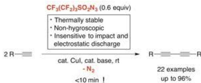
Figura 1. Acoplamiento de tipo Glaser extremadamente rápido y eficiente promovido por la azida de nonafluorosulfonilo.
